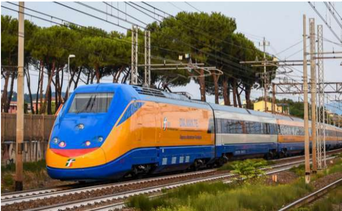
Il treno diagnostico Diamante per le linee ad alta velocità Fonte: RFI
